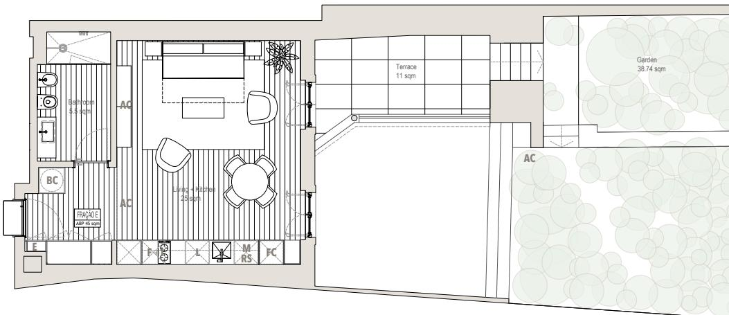
**FC** Frigorífico/Congelador **BC** Bomba de calor **E** Quadro Elétrico **I** Placa de Indução **L** Máquina de Lavar Loíça **M** Micro-ondas **F** Forno **RS** Máquina Lavar/Secar Roupa **AC** Ar Condicionado
